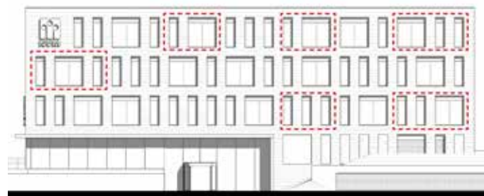
Een gevarieerd gevelbeeld met een beperkt aantal verschillende gevelelementen.
